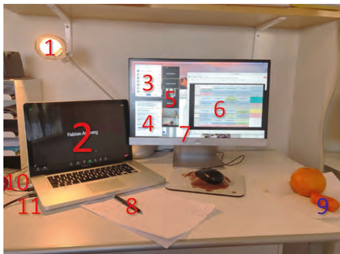
Figur U. Om du ska delta i (eller hålla i!) en digital kurs är det viktigt med förberedelser. En laptop (med inbyggd kamera) står tillsammans med minst en extra skärm. 1: Se till att ha ljus på ansiktet (framifrån) så att du ser presentabel ut. Endast ljus uppförifrån eller bakifrån blir inte bra. Är du en smula fåfång kan du höja laptopen lite så att kameran inte ser dig nedifrån. 2: På laptopens skärm (där kameran sitter) bör du ha själva Zoomfönstret, så att du naturligt vänder dig mot kameran när du pratar. På den extra skärmen (eller skärmarna) bör du ha: 3: Ett fönster med deltagarlistan (och eventuellt väntrum). 4: Chattrfönstret, för att snabbt se och fånga upp frågor och kommentarer. 5: Bildfönstret på deltagarna (eller ha detta infällt i Zoomfönstret). 6: Schemat. 7: Övriga fönster, såsom handouts och mail. Övriga tips: 8: Papper och penna för fortlöpande minnanteckningar till diskussioner och frågor. 9: Morot. Långsamma kolhydrater är bra vid stillasittande. 10: Internetkabel är stabilare än wifi. 11: Headset med sladd funkar bättre än trådlös. Datorns inbyggda mikrofon har ofta dålig ljudkvalitet och aktiv brusreducering som kan ge märkliga biljud. Det ska vara behagligt att lyssna på dig! Det räcker inte med att du hörs.
