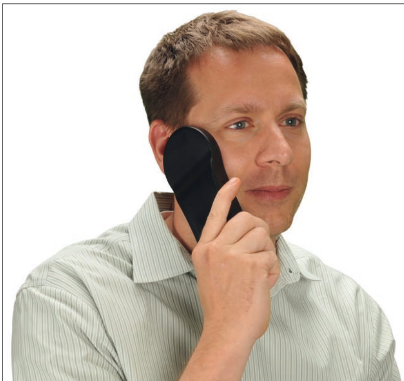
Figur 2. Den implanterade stimulatorn aktiveras av patienten med en fjärrkontroll som kommunicerar med stimulatorn via radiofrekvensvågor. Även programmering av stimulatorn sker med hjälp av fjärrkontrollen.
