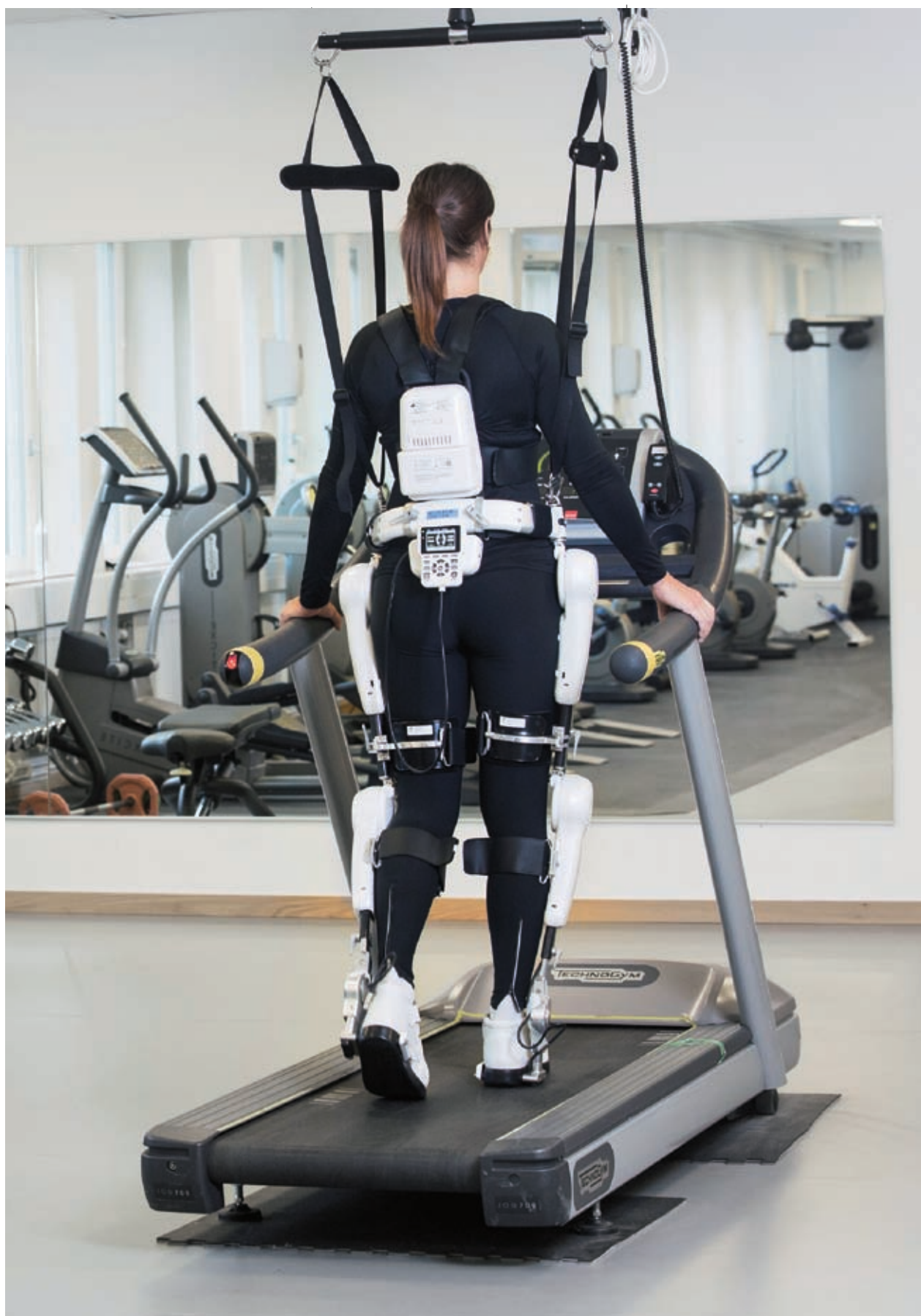
Figur 4. Träning med HAL med viktavlastande sele på gåband. Viktavlastningen är vanligen kring 20 procent av kroppsvikten och anpassas fortlöpande med hänsyn till grad av HAL-assistans och gånghastighet.
